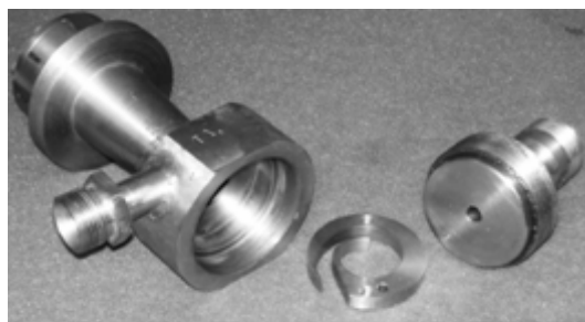
Устройство вихревой трубы
